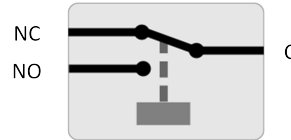
Röle yapılandırması (enerji verilmemiş).
