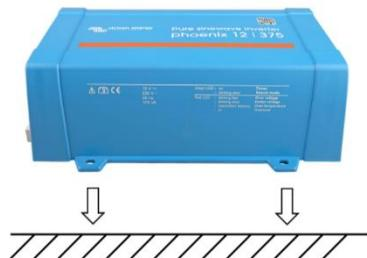
İnvertörü dikey ya da yatay olarak; yukarı veya aşağı dönük olarak şekilde (Şekil 1'de gösterildiği gibi) sağlam bir duvara veya yatay olarak uygun bir zemine (Şekil 2'de gösterildiği gibi) dört vida ile monte edin. Diğer cihazlarla/şeyalarla arasında en az 4 inç (10 cm) mesafe bırakın. **İnvertörü bir yüzeye baş aşağı pozisyonda monte etmeyin.**
